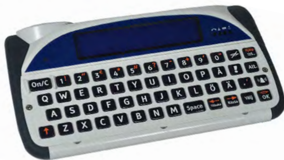
LightWriter SL40 Connect har inbyggd mobiltelefonfunktion så att användaren kan sms:a eller ringa telefonsamtal med hjälp av den inbyggda talsyntesen.
